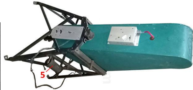
Espectrógrafo I. 1. Tapa de acceso al porta placas, 2. termómetro, 3. ubicación del porta ocular guía, 4. espejos de guía y para el espectro de comparación, 5. lámpara de arco de hierro, 6. control de termóstato, 7. gancho para montaje/desmontaje del instrumento (S. Paolantonio y M. Bozzoli 2023).
