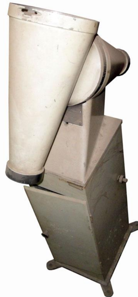
Tubo y montura de la cámara Schmidt 20/32 cm. En la parte inferior del tubo puede verse la puerta que da acceso al porta placas. En el interior del pilar se ubica el sistema de relojería (S. P. 2012).
