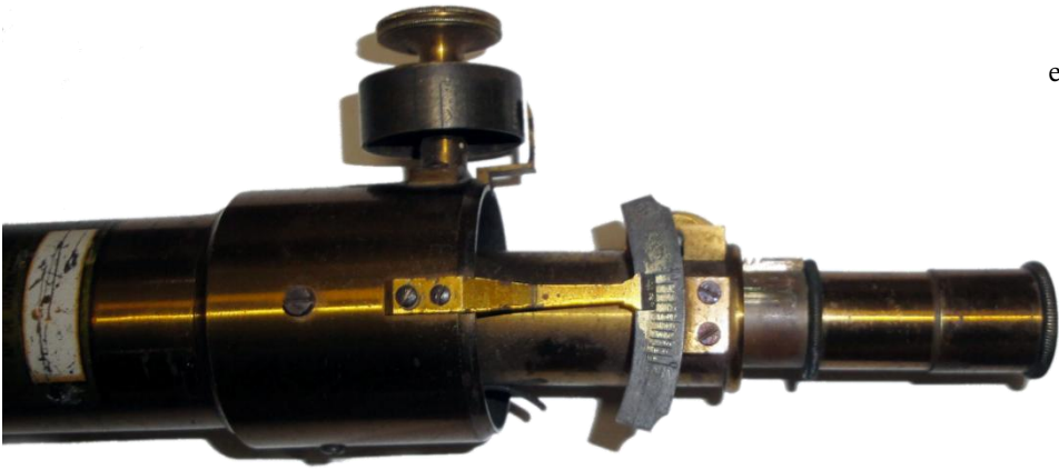
Detalle del extremo del ocular, con la escala y nonius (S.P. 2012).
