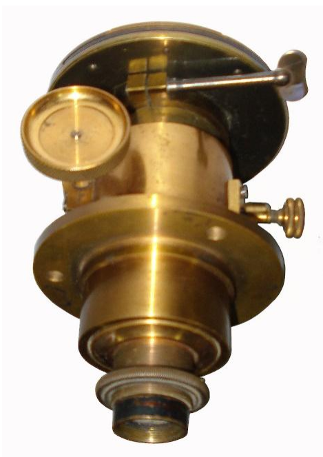
Dos vistas del microscopio izquierdo (fijo) de la máquina de medir Troughton & Simms. Abajo le falta el ocular (S.P. 2011)
