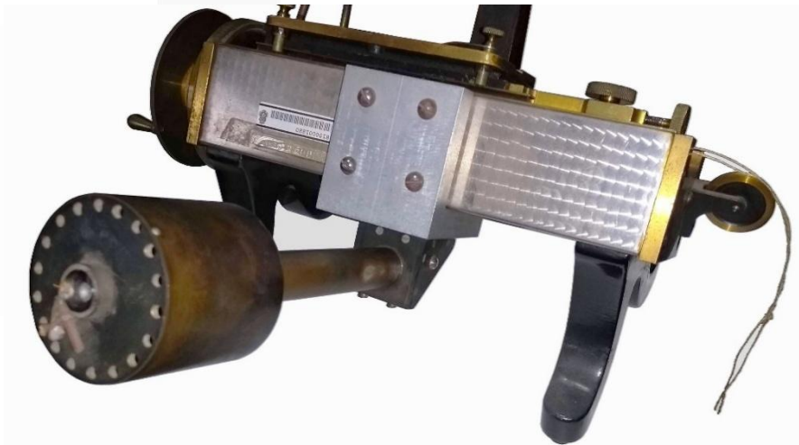
Detalle del sistema de iluminación artificial, modificación realizada en la institución (S.P. 2020).
