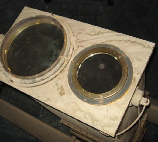
Objetivos del Astrográfico, izquierda, fotográfico, derecha, del anteojo guía (S. P. 2011).
