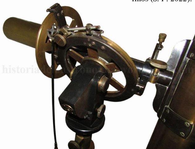
El telescopio cuenta con círculos graduados en declinación y ascensión recta, y movimientos finos (S. P. 2022).
