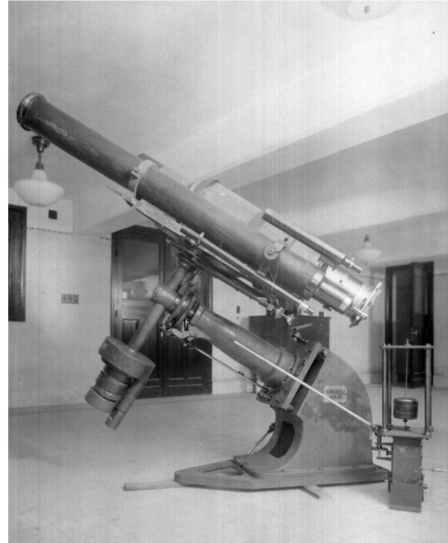
Astrocámara Hans Heeler armada en el subsuelo de la actual sede del Observatorio circa 1930. A la derecha puede apreciarse el sistema de relojería.
