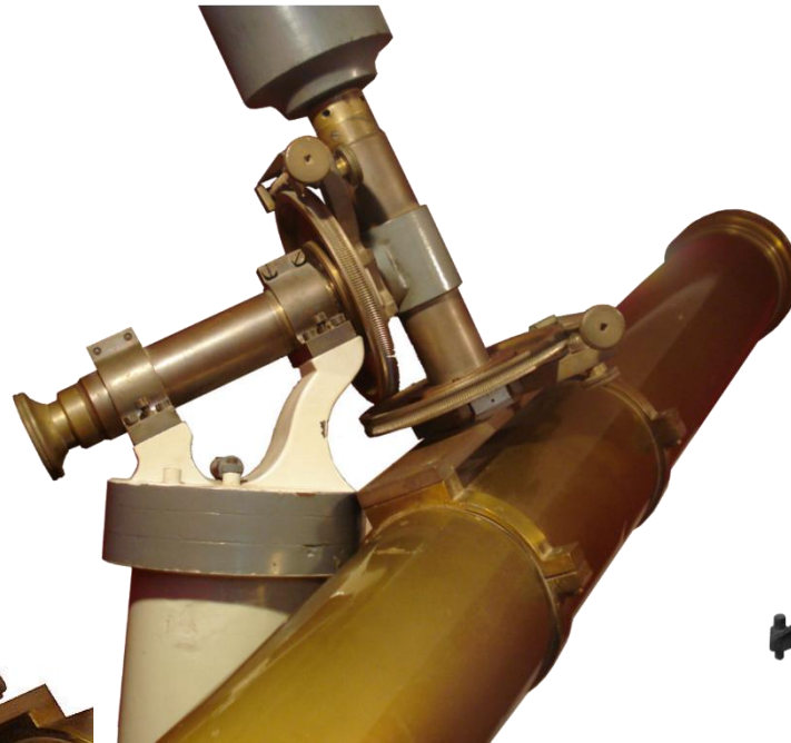
Abajo, detalles de los ejes polares y de declinación del telescopio Alvan Clark (S. P. 2011).
