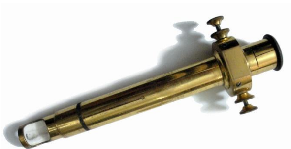
Microscopio para controlar la posición del péndulo del reloj patrón Riefler N° 330 (S.P. 2012).
