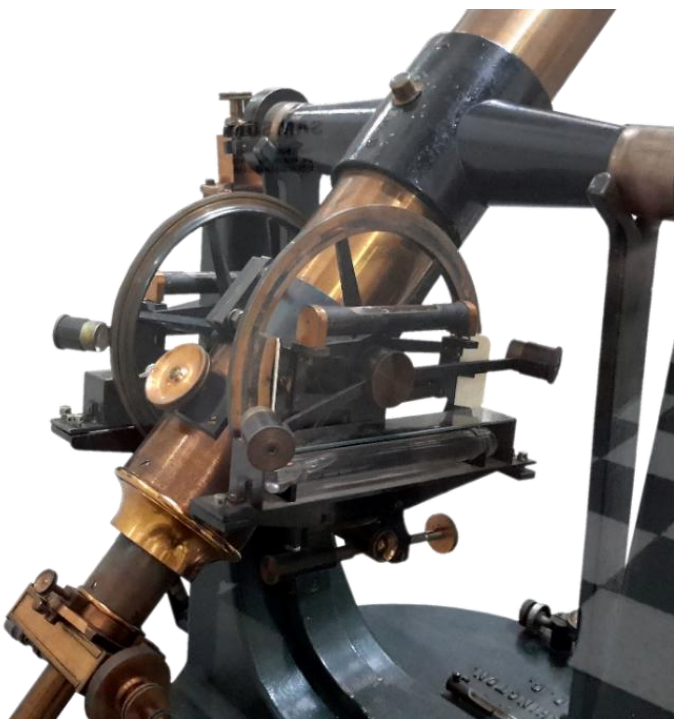
Detalle de los círculos verticales del anteojo Fauth (S. P. 2014).
