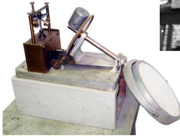
Izquierda, celóstatp 1 con la cubierta de aluminio colocada, puede verse el espejo y arriba el freno del giro. Derecha, el instrumento sin la cubierta, donde se aprecia el espejo, el sistema de relojería y el sin fin y la corona (S.P. 2011).
