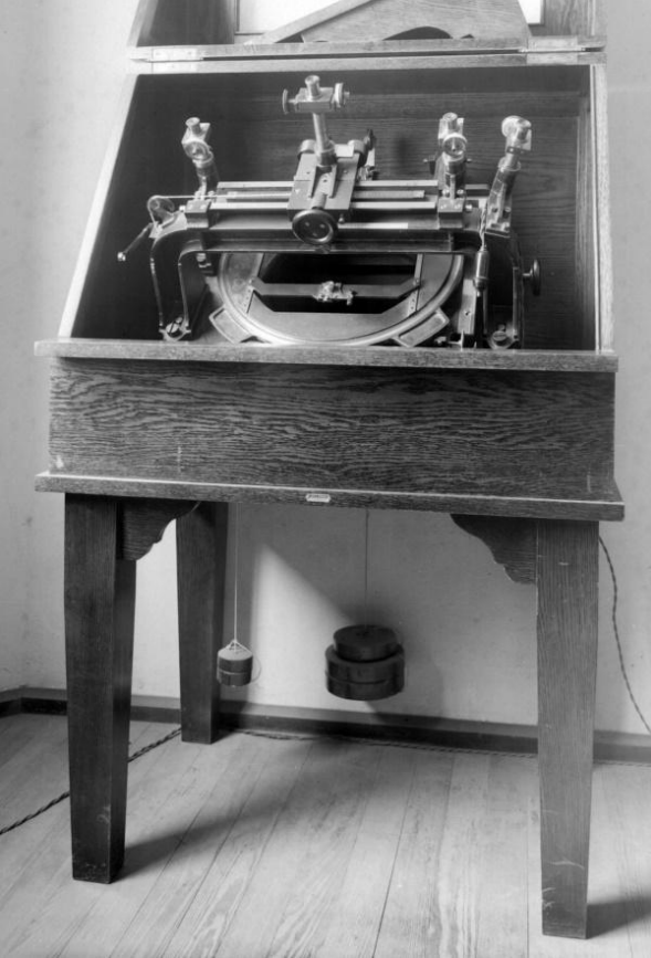
Máquina de medir placas Repsold en la época de su empleo para el Catálogo Astrográfico. Abajo pueden apreciarse las pesas que tensionan los carros
