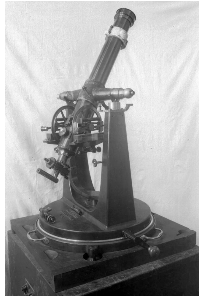
Anteojo de tránsito y cenital Fauth el 4 de junio de 1935, mostrado en proceso de inversión. Ese año se realizó la modificación de los extremos del eje, encamisando los muñones para transformarlos en esféricos.
