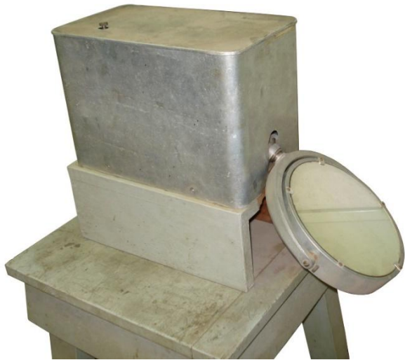
Izquierda, celóstatp 1 con la cubierta de aluminio colocada, puede verse el espejo y arriba el freno del giro. Derecha, el instrumento sin la cubierta, donde se aprecia el espejo, el sistema de relojería y el sin fin y la corona (S.P. 2011).
