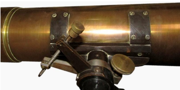
Abajo. Detalle del movimiento fino del eje de declinación (S. P. 2022).
