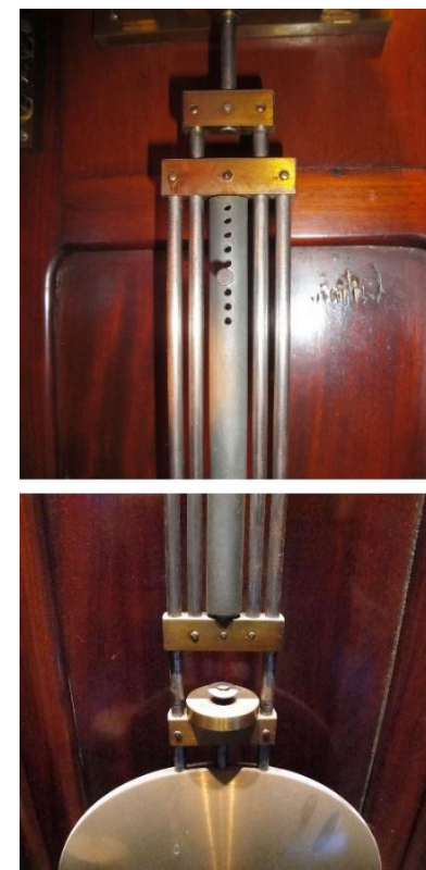
Detalle de los extremos del péndulo compensado del reloj Teide del ONA (S.P. 2012).
