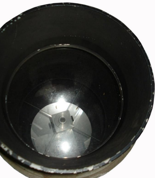
Vista desde el extremo del tubo de la cámara Schmidt 20/32 cm. Puede verse la lente correctora de Ø 202 mm, el porta placa cuadrado y al fondo el espejo de Ø 315 mm, aluminizado (S. P. 2012).
