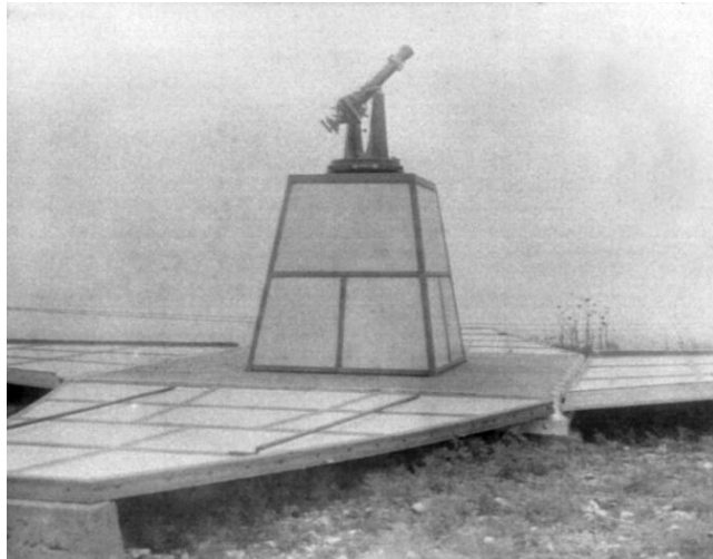
Anteojo de tránsito y cenital Fauth instalado en la Estación Astrofísica de Bosque Alegre, circa 1935.
