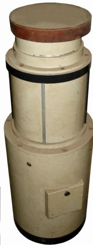
Tubo y montura de la cámara Schmidt 20/32 cm. En la parte inferior del tubo puede verse la puerta que da acceso al porta placas. En el interior del pilar se ubica el sistema de relojería (S. P. 2012).
